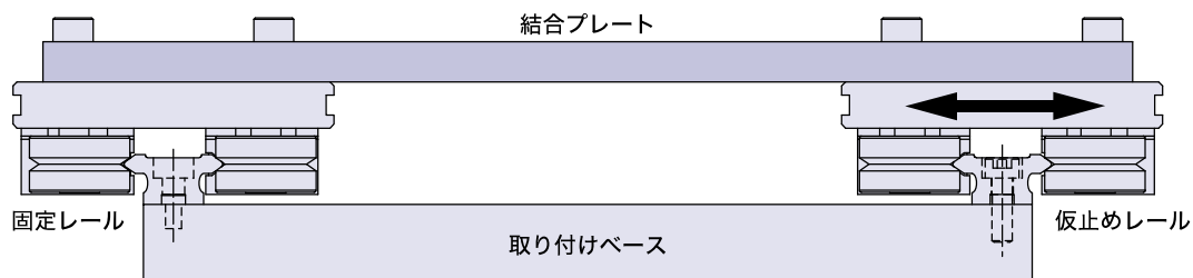
図3.2 レールの取り付け方法 2 (ノックピンの使用)
