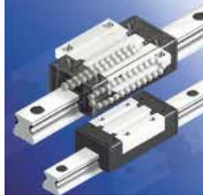
アルミニウム製レールにステンレスのボール軌道面を備えた画期的なシステム。劇的な軽量化により装置重量を低減しコスト削減になるばかりか、一定の防錆効果も期待でき、これまでのスチール製ガイドでなしえなかったパフォーマンスを実現します。
