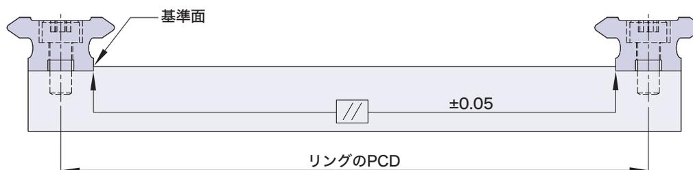
図3.1 レールの取り付け方法 1
