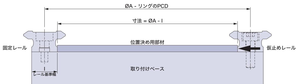
図3.3 レールの取り付け方法 3
